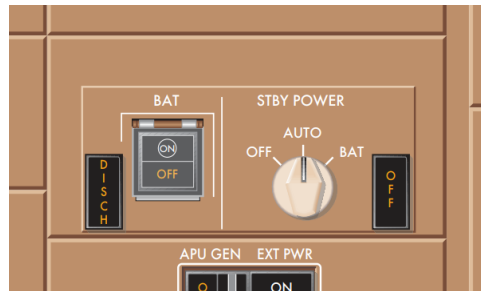
Рисунок 55. MAIN BATTERY SWITCH.
